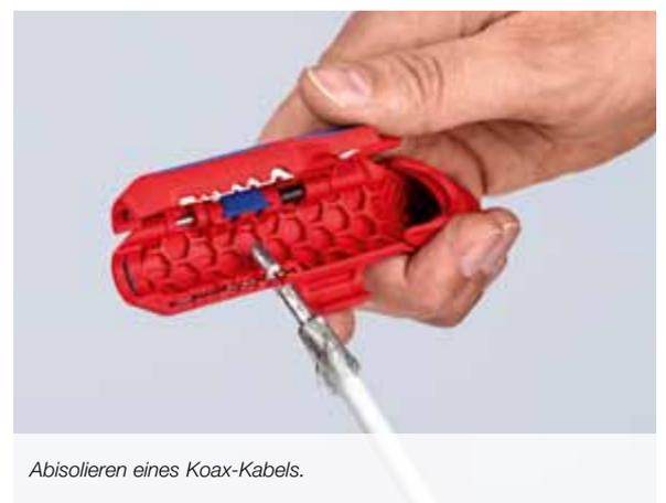
Abisolieren eines Koax-Kabels.
