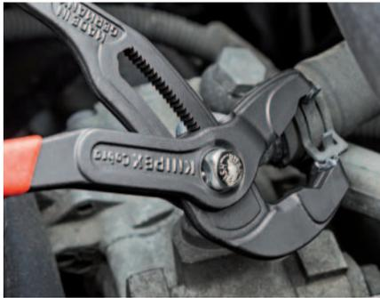
Mit der neu entwickelten Federbandschellenzange bietet KNIPEX – gerade den Kfz-Werkstätten – eine einzigartige Alternative zu den bestehenden Lösungen. Denn sie schafft sie alle: Die Zange greift Standard-, Raumspar- und Drahtschellen und sogar Federbandringe in einem Durchmesserbereich von 0 – 70 mm. Das macht sie einzigartig auf dem Markt.
