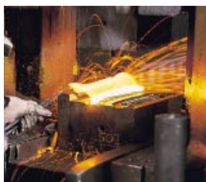
Mit 2,5 t Druck und bei Temperaturen von 1.200 °C werden KNIPEX-Zangen im Gesenk geschmiedet.
