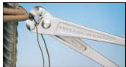
Leichteres Arbeiten durch optimale Übersetzung mit der Kraftmonierzange.
